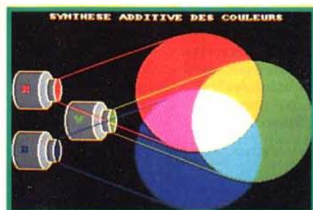
Le mélange des couleurs lumière (RVB) se fait suivant les règles de la synthèse additive.
